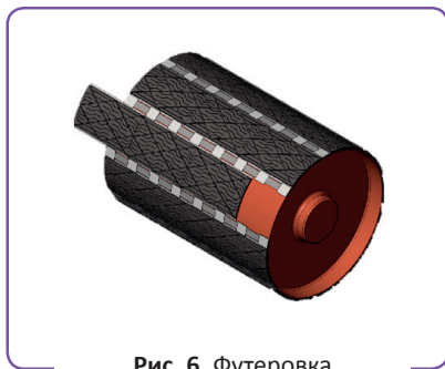
Рис. 6. Футеровка на приварных направляющих
