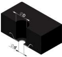
VW — сквозное отверстие с шайбой
