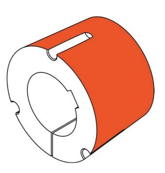
Предлагаемые втулки отвечают соответствующим стандартам и взаимозаменяемы с изделиями других производителей. Отверстия и шпоночные пазы обработаны в соответствии с BS 4235: часть 1 и DIN 6885, а конструкция обеспечивает надежный монтаж даже на изношенных валах. Защитные покрытия (фосфатирование и оксидирование) обеспечивают повышенную коррозионную защиту втулок.
