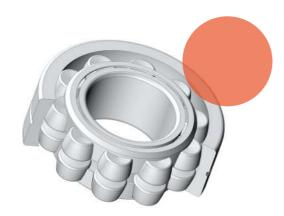
— Сферические роликовые подшипники. Предназначены для работы в условиях высоких радиальных нагрузок, недостаточного смазывания, высоких скоростей и повышенной загрязненности, а также для частичной компенсации несоосности
